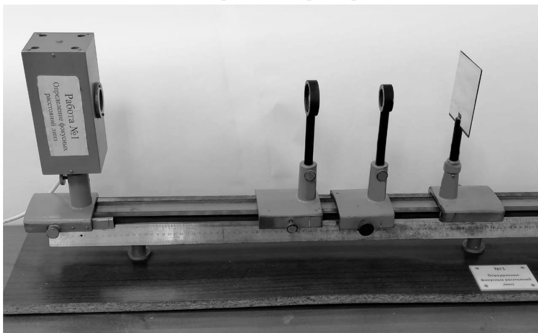
Рис. 1.3. Экспериментальная установка по измерению фокусных расстояний линз
