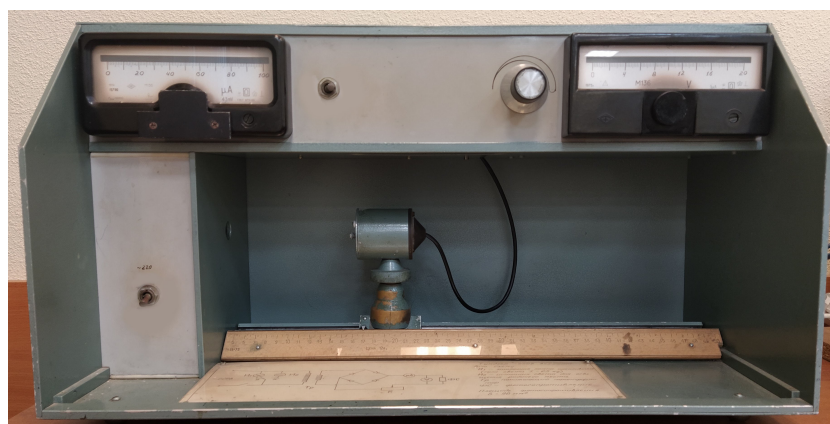
Рис. 7.3. Экспериментальная установка по исследованию внутреннего фотоэффекта
