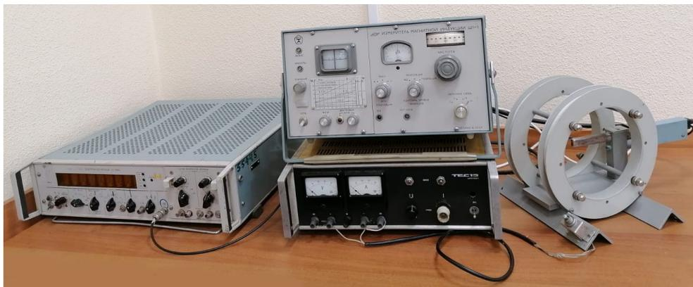
Рис. 8.5. Упрощенный спектрометр ЭПР
